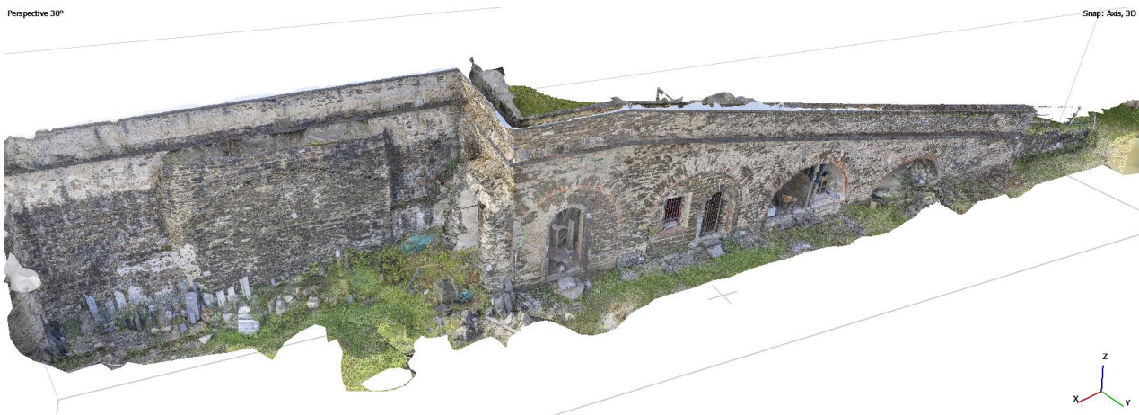
Abb. 9: Photogrammetrisches, texturiertes und maßstäbliches 3D-Modell.
